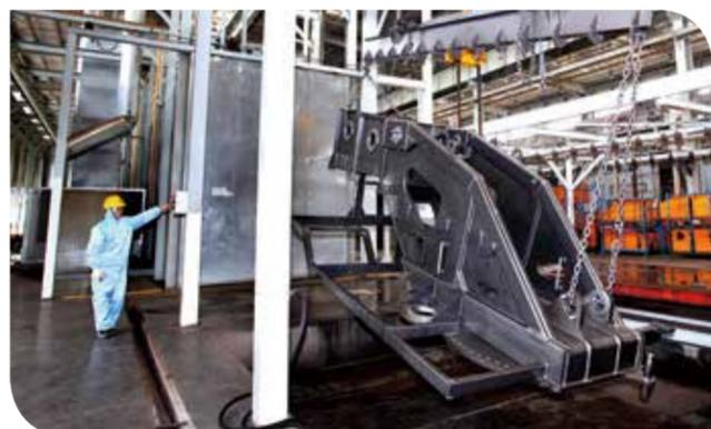
> **表面处理**：采用先进的自动喷淋清洗工艺，极大地提高油漆附着力和耐腐蚀性能。
