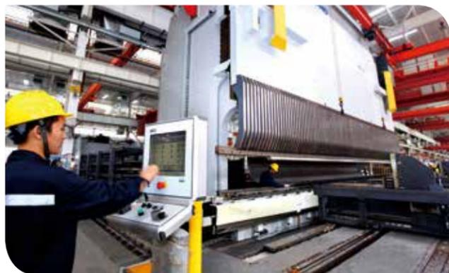
> **成型**：拥有亚洲首台带激光在线检测、全程多点智能补偿系统、自适应大尺寸折弯件托扶机构的3000T折弯机，“一次成型”技术全面得到并广泛应用。
