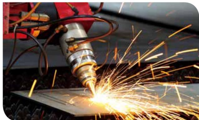
> **下料**：全面应用激光割和精细等割，辅以圆弧变速、网络编程等先进技术，下料精细化水平行业领先。
