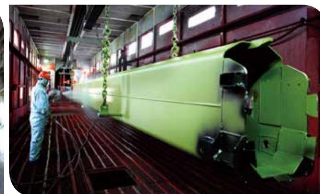
> **涂装**：采用行业领先的静电喷涂工艺、电泳工艺及边角处预喷涂工艺，极大地提升防腐性能。
